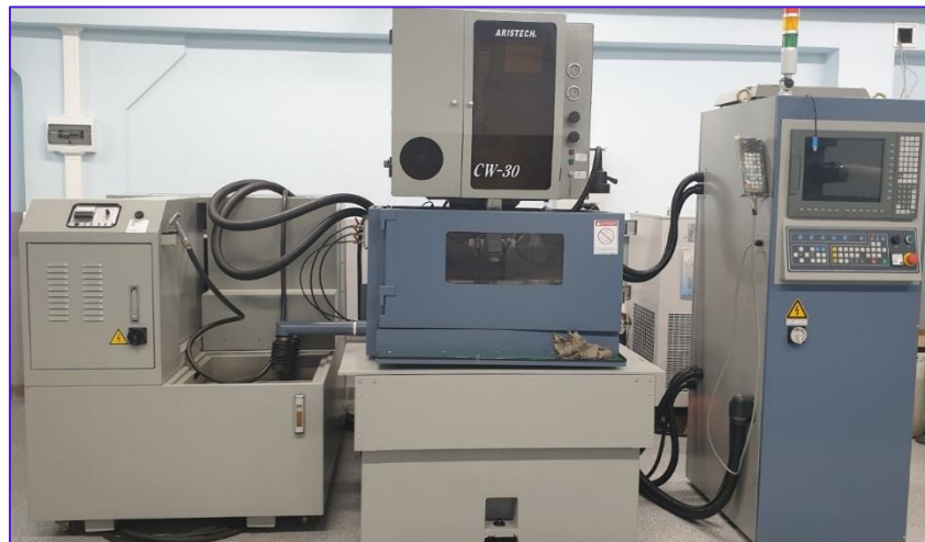
Электроэрозионный проволочно-вырезной станок погружного типа CW-30
