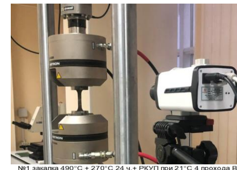
№1 закалка 490°C + 270°C 24 ч. + РКУП при 21°C 4 прохода ВС
